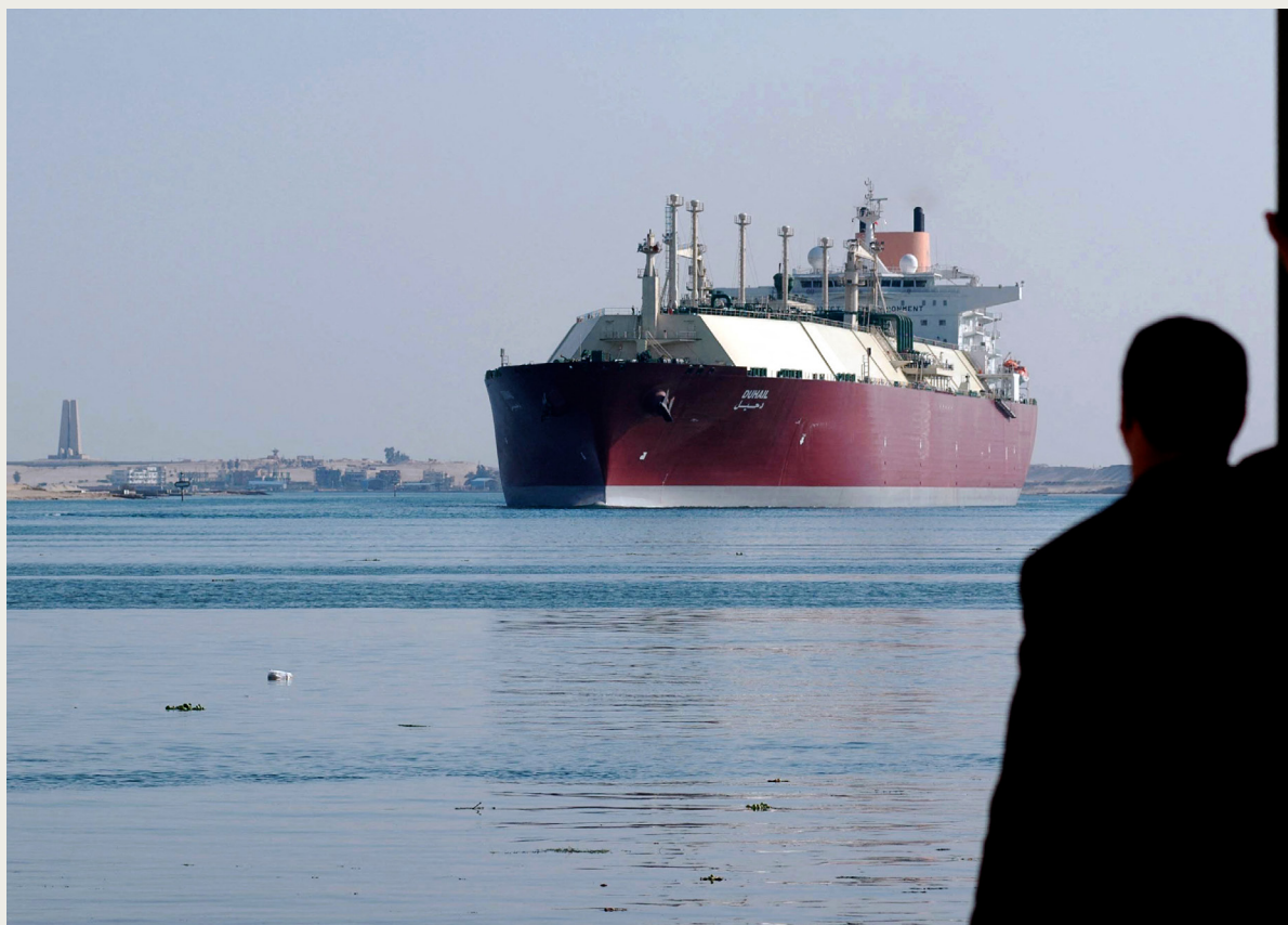
Le Duhail , navire qatari, avec sa capacité de 210 100 m 3 , est l'un des plus grands méthaniers construits à ce jour.
